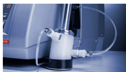
Modules de mesure des boissons pH ME / pH ME Beverage
