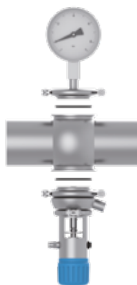
Les raccords de la chambre de mesure VARINLINE® permettent d'installer jusqu'à deux instruments
